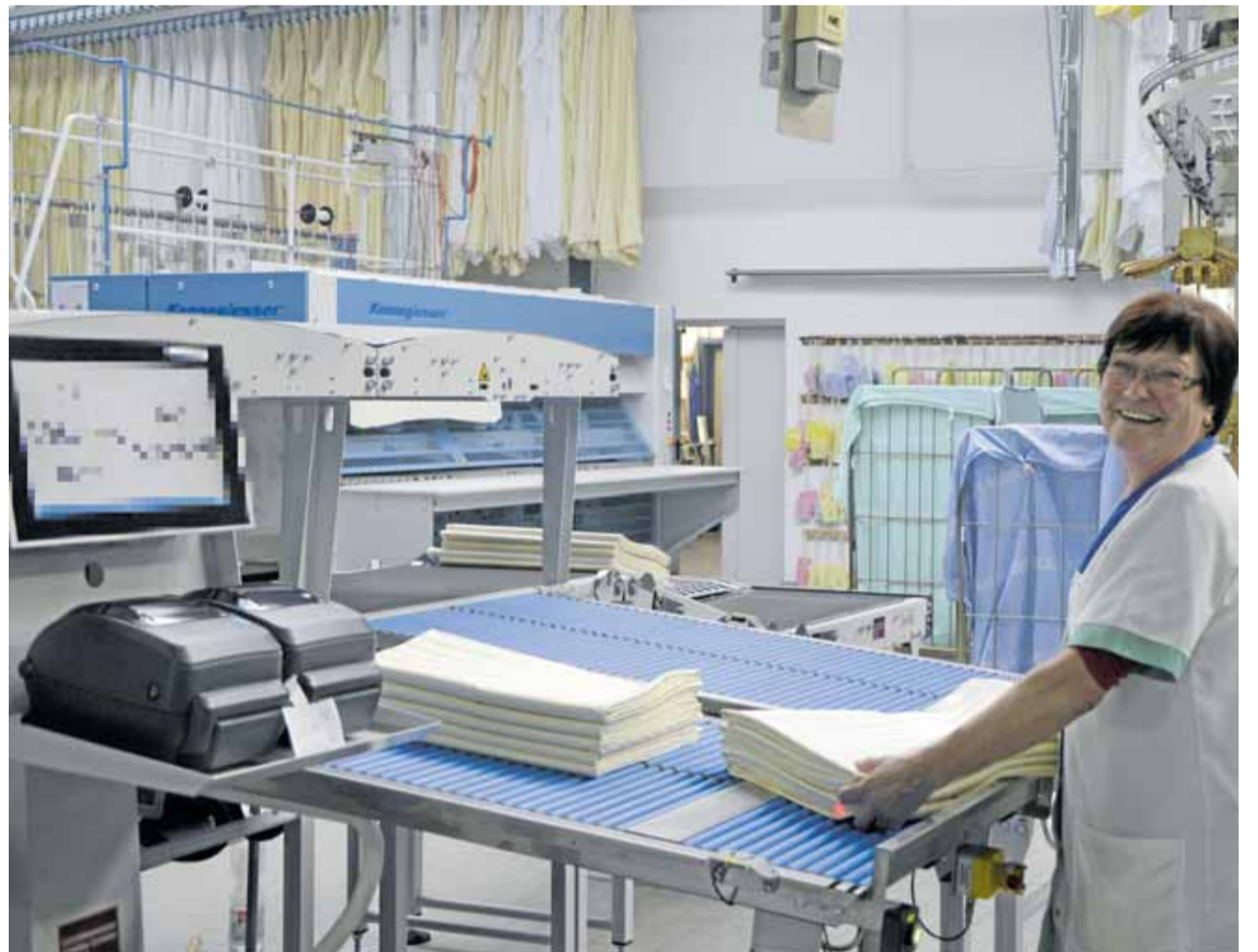
Marianne Bosse ist eine von sechs Mitarbeitern, die jetzt an der neuen Bügelmaschine stehen. Hier werden die fertig gebügelten Wäschestapel sortiert – der Abschluss von etlichen Schritten, die die Laken in der Maschine durchlaufen. Foto: Meyer-Zurwelle
